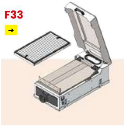
F33 | Plaatsing Partikel filter
